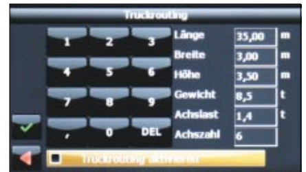
Individuell anpassen lassen sich die Vorgaben für die Trucknavigation entsprechend des eigenen LKWs
