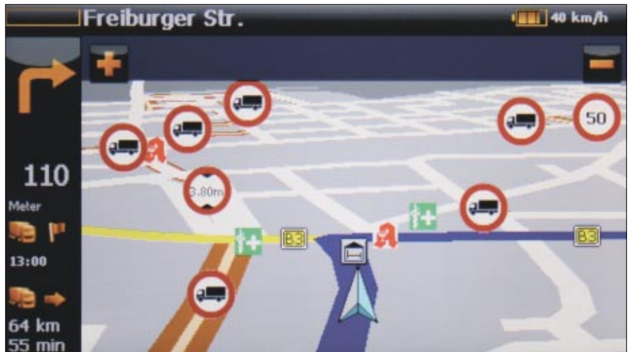
Während der Trucknavigation zeigt das Navtrip enge Straßen und niedrige Brückenhöhen an und lotst um diese Gefahrenpunkte
